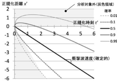
図-3 衝撃波の確率分布 (ボトルネック位置  $x=0$ )
