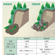
図：表層崩壊と深層崩壊（林野庁HP[B-14]より引用）
